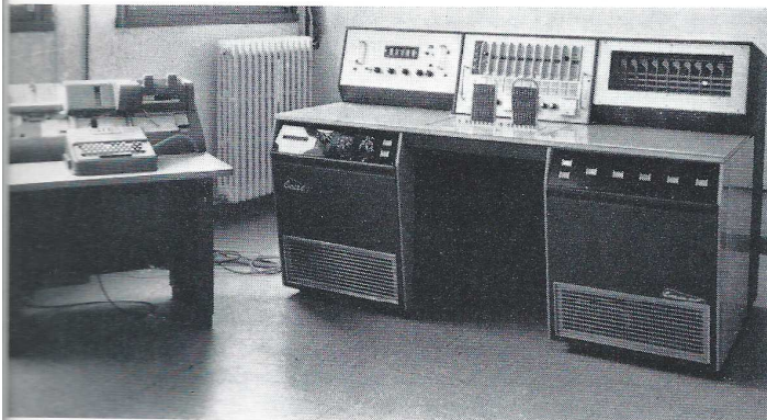
Appareil de mesure automatique de transistors « Tacite » utilisé au centre d'essais de fiabilité à Lannion
