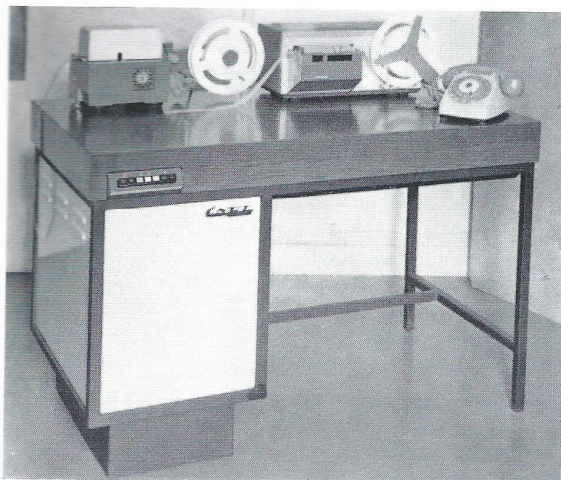
Équipement de transmission de données reliant les centres de calcul du CNET, entre Lannion et Paris, réalisé à l'aide de circuits intégrés
