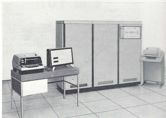
Centre de traitement des informations, construit par la CIT, autour d'un calculateur 10 010 de la CII (partie haute du bâti de droite).
