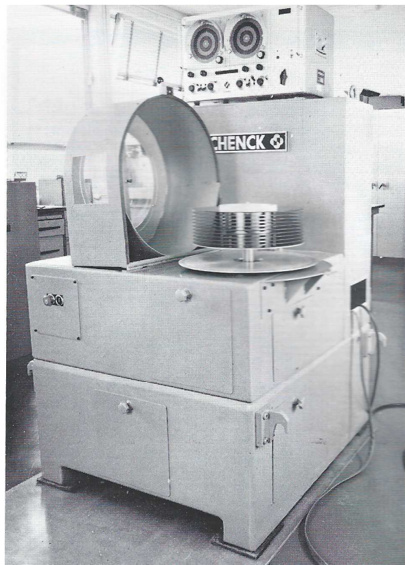
Machine servant à équilibrer les disques magnétiques, ces disques qui servent de mémoire au calculateur tournent à très grande vitesse, et il est nécessaire que leur équilibrage soit particulièrement soigné
