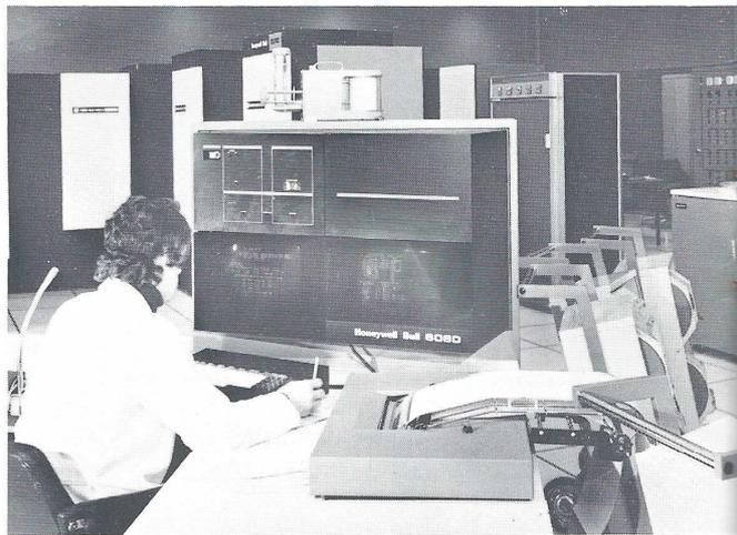
Le H 6080 bi-processeur dont tous les éléments centraux sont doubles, a une structure modulaire particulièrement adaptée aux impératifs d'exploitation du CNET, exploitation très orientée vers le télétraitement. Cette structure offre de nombreuses possibilités de reconfiguration permettant d'assurer une permanence du service en cas de défaillance d'un, voire de plusieurs éléments.
